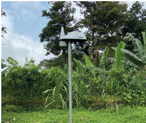
**Img. 1** Estação meteorológica instalada no centro de processamento de café em Bemposta.
