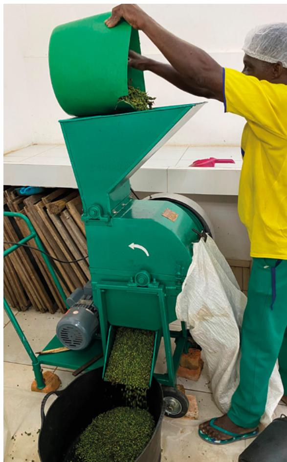
Img. 106 Máquina debulhadora.
